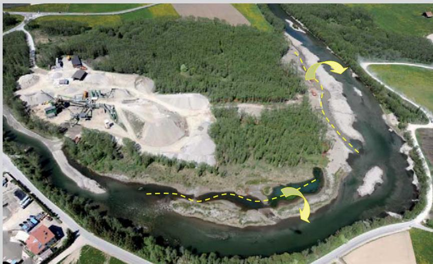
Figura 21.- Creazione di un canale secondario (in giallo) lungo il Torrente Aurino (Bolzano). (tratto da: CIRF (2009). Rivista "Riqualificazione fluviale", Numero 2/2009. Articolo "Riqualificazione fluviale in Alto Adige: gli interventi sul basso corso del torrente Aurino")
