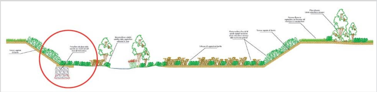
Figura 24 – Progetto per la sistemazione idraulico-ambientale del Torrente Raio (Provincia dell'Aquila). In rosso è indicata una difesa spondale interrata in massi. (Immagine: Commissario Delegato per l'emergenza socio-economica-ambientale del bacino del fiume Aterno-Pescara. Progetto a cura di BETA studio srl. e HR Wallingford con la collaborazione di: Dott.ssa Ileana Schipani, Ing. Marco Monaci)
