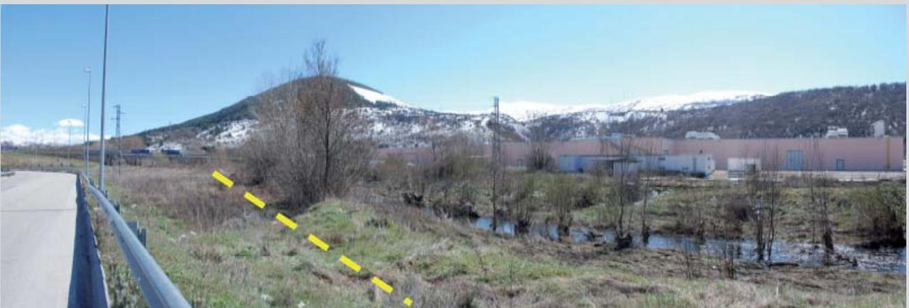
Figura 25 – Torrente Raio; in giallo la posizione indicativa in cui sarà posizionata la difesa spondale interrata in massi (Foto: Ileana Schipani)
