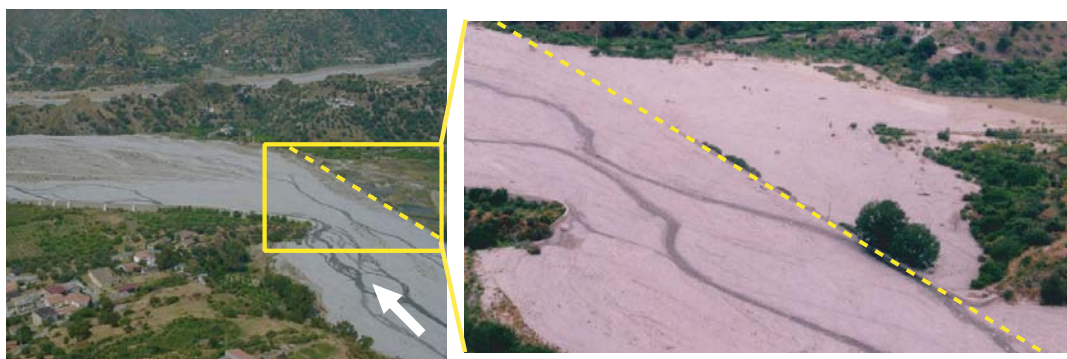
Fig. 18.6. Fiumara Amendolea, località Borgo Amendolea, vista dall'alto. A sinistra: prima della piena del dicembre 2003. A destra: ingrandimento dell'area riquadrata nella foto di sinistra, ripreso nel 2004. La freccia indica la direzione della corrente. La piena del dicembre 2003 ha provocato una rottura dell'argine (la cui posizione è segnalata dalla linea tratteggiata), depositando nella piana ingenti quantitativi di detriti solidi. (Foto: F. Scionti)
