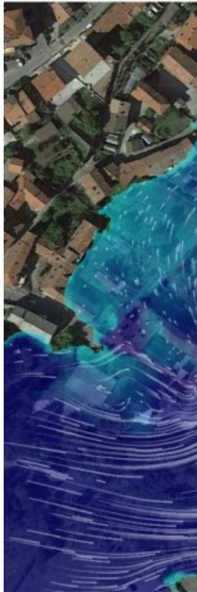
**Modello idraulico per la definizione delle aree esondabili per portate con tempo di ritorno di riferimento e per la valutazione del transito delle piene formative**
