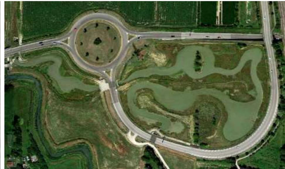
Il progetto si inserisce all'interno della rete viaria che attraversa l'area nord del Comune di Mogliano Veneto, con un intervento che ha portato ad avere due bacini contigui di fitodepurazione, per una superficie complessiva di 3.5 ettari.
