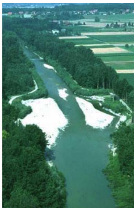
Figura 6 -: Riqualificazione del fiume Emme, prima (a sinistra) e dopo (a destra) l'intervento (Foto rielaborata da: Requena P., Weichert R.B. & Minor H.-E., 2006)
