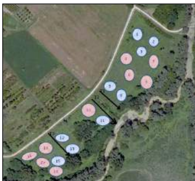
Figura 4 - Guado Paradiso rappresentato nelle ortofoto AGEA 2008. In rosa, le macchie su cui è stato eseguito il rilievo floristico; in azzurro, quelle su cui è stato effettuato anche il rilievo dendrometrico. Sono, inoltre, indicati nell'immagine i 3 transetti (T1, T2, T3) con cui è stata rilevata la matrice.
