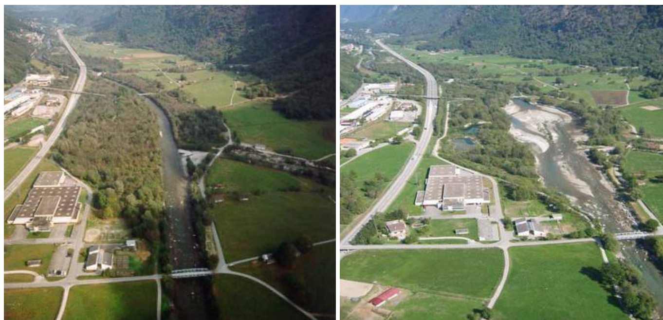
Figura 2 - Il Fiume Moesa vicino a Grono (Pascoletto) prima e dopo gli interventi conclusi nel 2000; classico esempio di restituzione di spazio al corso d'acqua.
