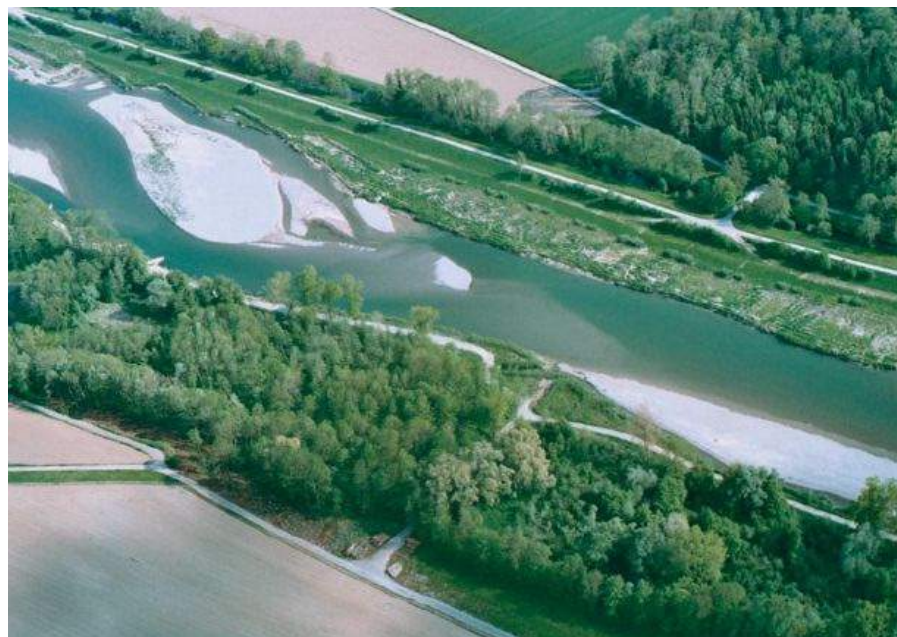
Figura 1 - Esempio di ampliamento dell'alveo per favorire la riattivazione delle dinamiche morfologiche, lungo il Fiume Thur (fonte: FOWG).
