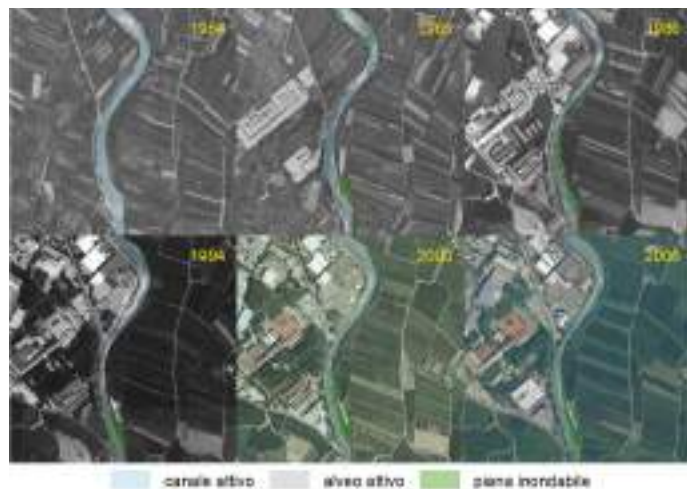
Figura 7 - Analisi della serie storica delle foto aeree per la ricostruzione dell'evoluzione dell'alveo e delle sue forme; la drastica riduzione del canale attivo tra il 1954 e il 1965 è da imputare unicamente alla riduzione delle portate di magra in alveo; l'immagine del 1954, inoltre, permette di intuire come l'opera di regimazione avesse ridotto il fiume ad una ampiezza a volte inferiore a quella dell'alveo attivo..
