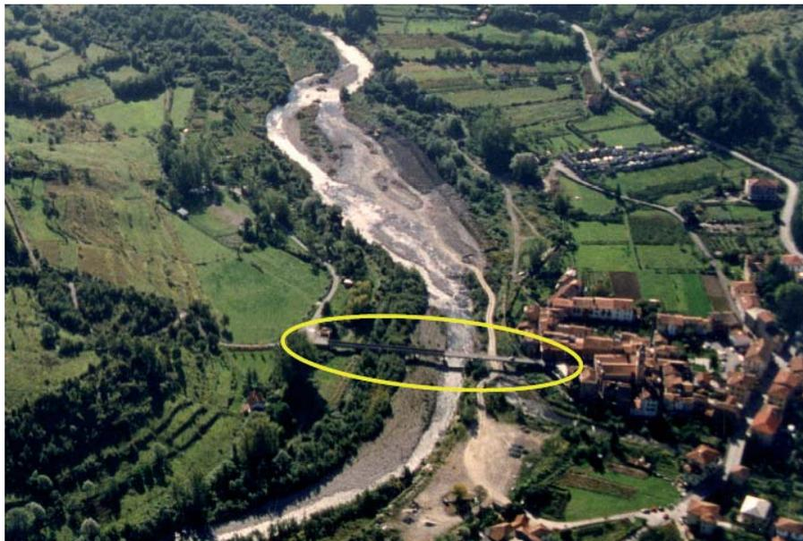
Figura 7 – Ponte sul Fiume Vara (SP). La sezione ristretta e gli stessi piloni del ponte inducono un rallentamento a monte e il conseguente deposito dei sedimenti. Si noti l'imprudente localizzazione del ponte e dell'abitato, situati proprio alla confluenza di due corsi d'acqua ove, di conseguenza, gli apporti solidi di entrambi si sommano e gli alvei hanno una spiccata tendenza alla divagazione laterale. (Foto: Parco Naturale Regionale Montemarcello-Magra)
