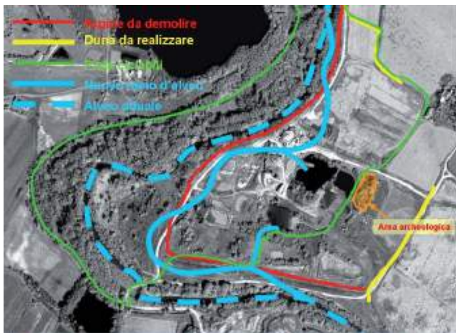
Figura 13 –Progetto di ripristino delle aree Sapifo (impianti di inerti) sul Fiume Ronco: creazione di nuovi rami secondari, abbattimento di argini e loro parziale ricostruzione in posizione arretrata.
