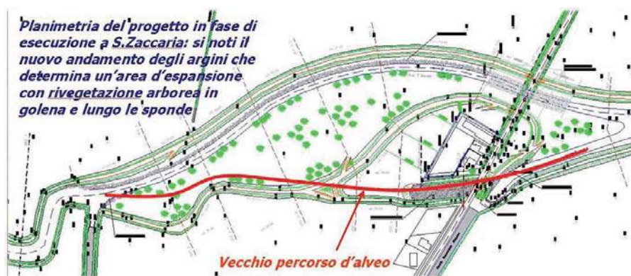
Figura 7 - Torrente Bevano: allargamento dell'ambito fluviale a S.Zaccaria (lavori in corso).
