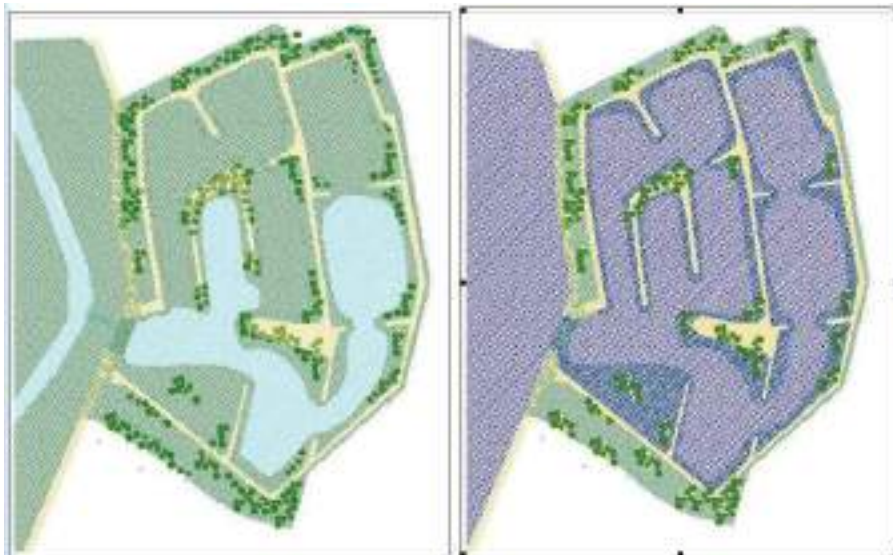
Figura 12 - Fiume Ronco – Area lagoni ex-SFIR: ipotesi di sistemazione a cassa d’espansione con valenza anche di area umida. Le simulazioni grafiche mostrano l’estensione della zona umida in estate e durante le piene massime previste.
