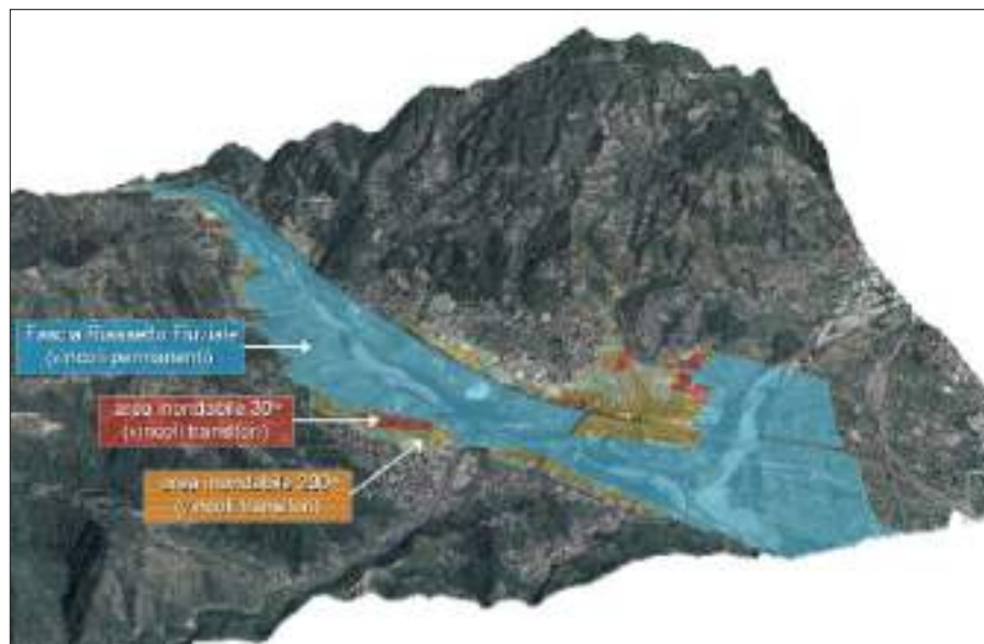
Figura 2 - La fascia di riassetto fluviale, finalizzata a restituire spazio al fiume, non è sovrapponibile alle aree inondabili. In alcuni tratti si estende a quasi tutto il fondovalle (escluse, naturalmente, le aree urbanizzate).
