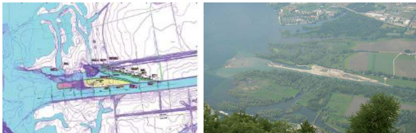
Figura 9 – Planimetria del progetto esecutivo (Da: Fondazione Bolle di Magadino e Andreotti & Partners, 2007), isola centrale: scavo a quota di progetto 194.5 m.s.m. (giallo) e riporto materiale per ampliamento isola (rosa). Immagine a destra: stato di avanzamento del progetto nel maggio 2009 (Foto A. Rossi-Pedruzzi).
