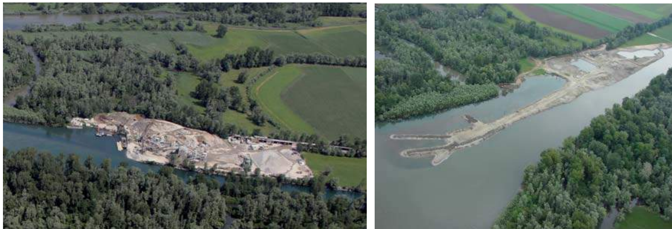
Figura 10 – Superfici golenali interessate dalle attività di estrazione e lavorazione inerti prima dell'inizio dei lavori (immagine di sinistra). Stato attuale di avanzamento dei lavori, 28 maggio 2009 (immagine di destra), è intuibile la posizione del canale laterale (quota 193.5 m s.l. m.) e l'abbozzo dell'isola centrale. Foto D. Pedrioli.
