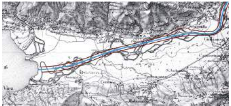
Figura 4b – Andamento del canale centrale (in blu) e degli argini insommergibili (in rosso) del fiume Ticino a seguito del progetto di rettificazione fluviale sovrapposto alla Carta Dufour del 1853. Sul documento del 1853 è ben leggibile il tracciato del fiume Ticino prima della rettificazione (Adattato da VAW, 2004).
