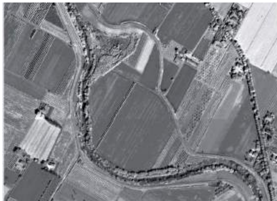
Figura 3 - L'area di S.Tomè sul fiume Montone prima dell'intervento. Si noti sulla sinistra il fiume, separato dall'ampia golena adibita a frutteto compresa tra il fiume stesso e l'argine maestro, a destra nella foto.
