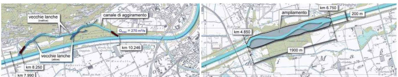
Figura 7 – Varianti di interventi di rivitalizzazione: settore Boschetti a Sementina, riattivazione vecchie lanche con canale di aggiramento (a sinistra); settore Cugnasco ampliamenti dell'alveo minore all'interno degli argini in sommergibili (a destra), da: VAW, 2004.
