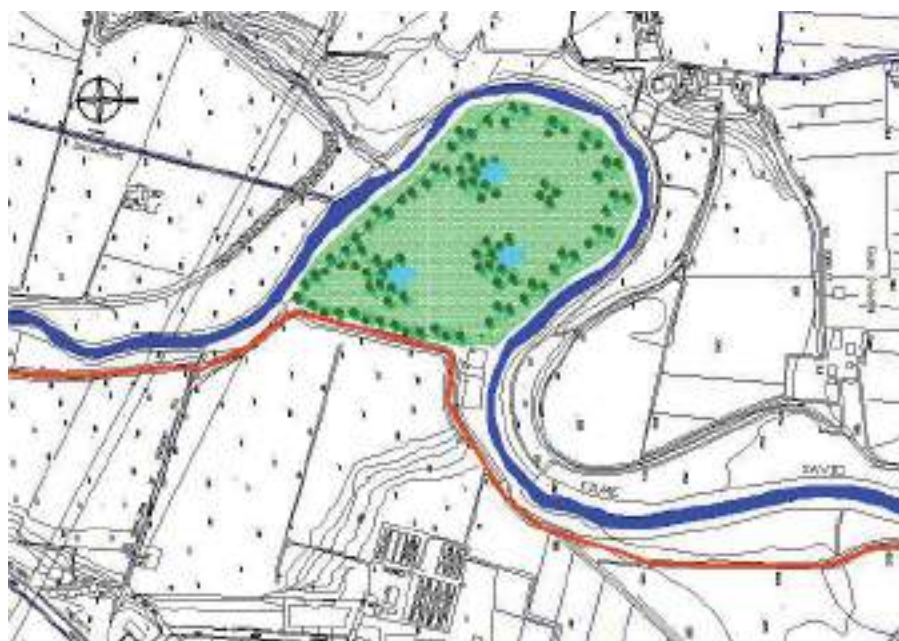
Figura 5 – Il fiume Savio e l'area di S. Anna in Comune di Cesena. L'argine che lambiva l'alveo all'interno dell'ansa è stato eliminato e ora il fiume può espandersi sino all'argine maestro (in rosso)..
