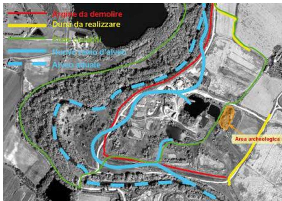
Figura 9 - Progetto di ripristino delle aree Sapifo (impianti di inerti) sul Fiume Ronco: creazione di nuovi rami secondari, abbattimento di argini e loro parziale ricostruzione in posizione arretrata
