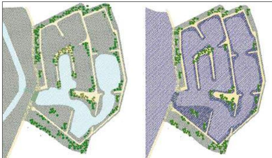
Figura 8 - Fiume Ronco - Area ex-SFIR: ipotesi di sistemazione a cassa d'espansione con valenza anche di area umida. Le simulazioni grafiche mostrano l'estensione della zona umida in estate e durante le piene massime previste)
