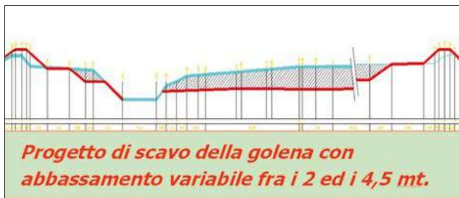
Figura 3 - Sezione tipo: allargamento dell'alveo realizzato mediante scavo di golena (azzurro: profilo nello stato di fatto; rosso: profilo di progetto; area retinata: materiale asportato dalla golena)
