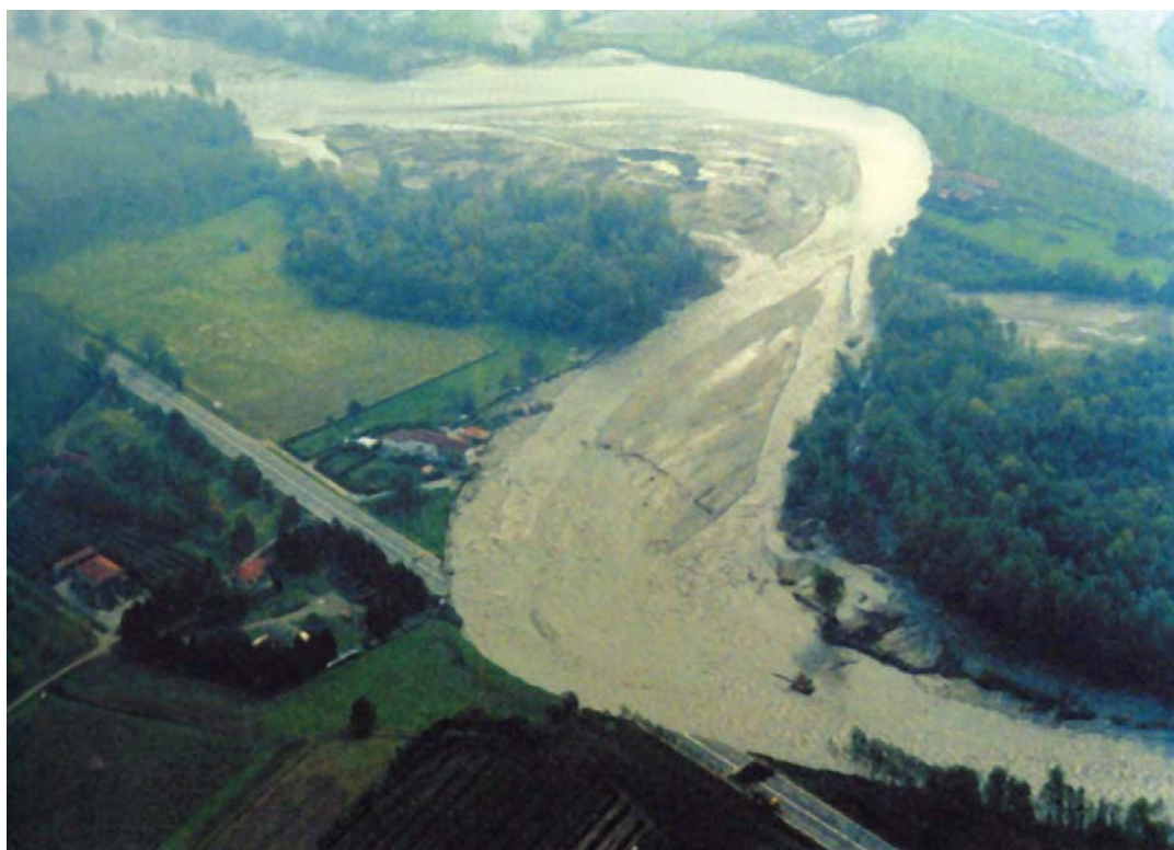
Fig. 2.28. Veduta aerea della tangenziale di Pinerolo (TO), asportata dal T. Chisone in prossimità della Cascina Tabona, durante la piena dell'ottobre 2000. I meandri continuano il loro processo, facendosi beffa delle protezioni. (TROPEANO e TURCONI, 2001, in NIMBUS)
