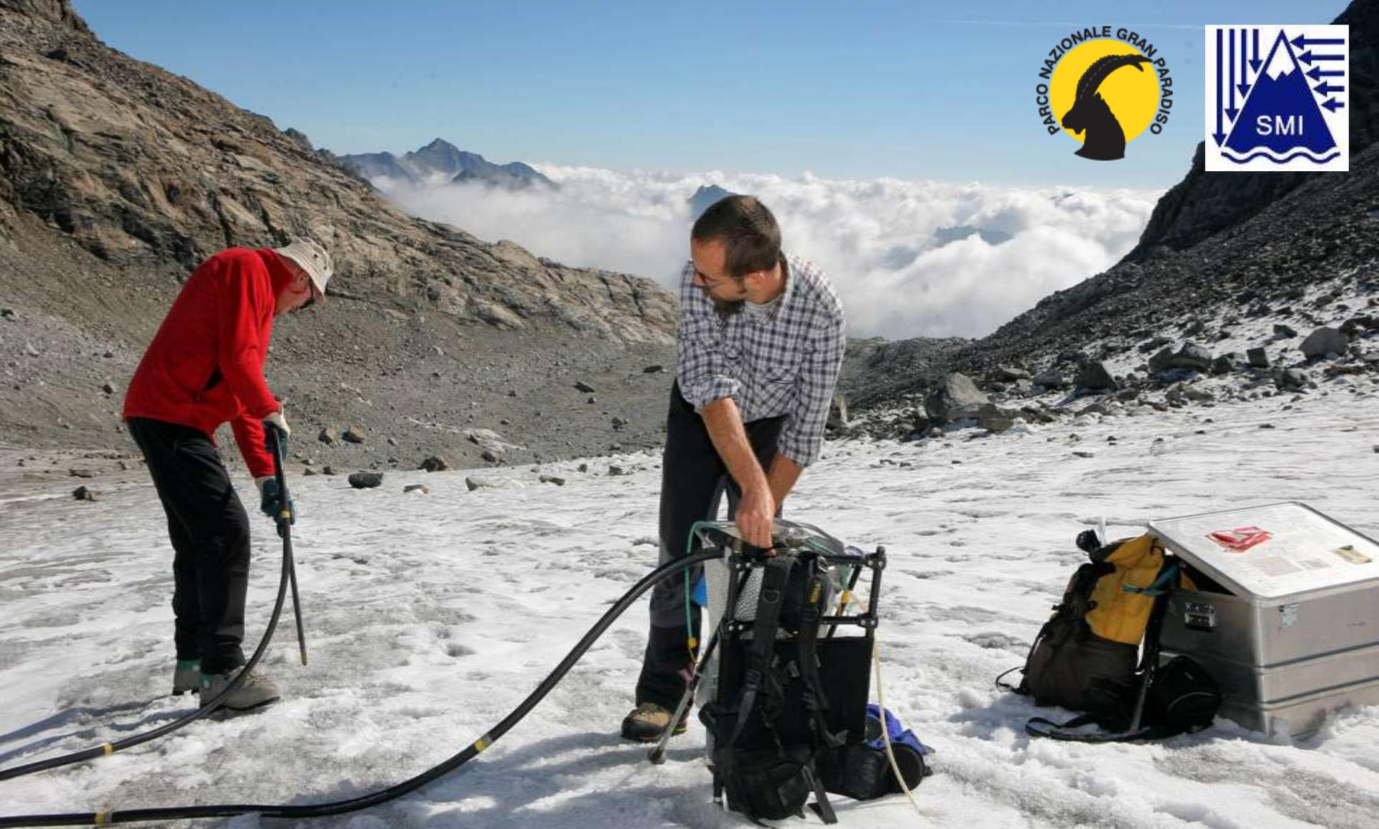
Rete di 6 paline ablatometriche per determinare le perdite annue di spessore glaciale.
