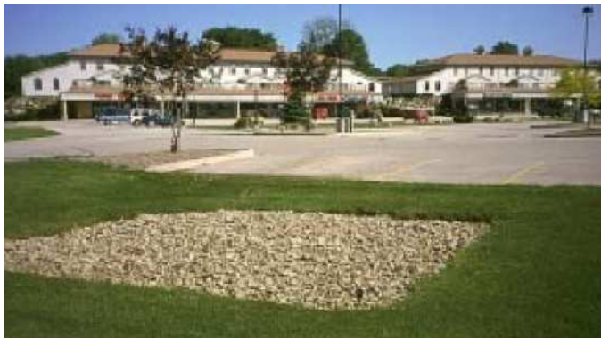
Trincea filtrante off-line applicata ad un parcheggio; (Fonte: Georgia Stormwater Management Manual)
