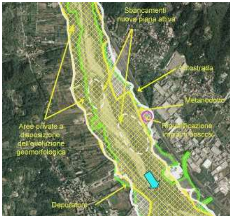
Figura 52 – Con riferimento allo studio dell’Autorità di Bacino del Magra riportato nella figura precedente, l’immagine permette di comprendere le modificazioni apportate alla fascia di mobilità funzionale definita su soli criteri geomorfologici una volta considerati gli aspetti di natura territoriale-urbanistica, al fine di definire la fascia di mobilità funzionale “compatibile”. Si osservi in particolare come in questo esempio la fascia di mobilità non si limiti alle sole aree demaniali e come siano previsti anche interventi per riattivare più velocemente alcuni processi geomorfologici. Linea bianca: confini della “Fascia di mobilità funzionale” derivante dalla fase di studio geomorfologico; linea gialla: confini della “Fascia di mobilità funzionale compatibile” di progetto, dopo la fase di mediazione con gli Enti (coincide con la linea bianca ove non vi siano state variazioni durante la fase di mediazione); linea verde: confine delle aree demaniali (si noti che la fascia di mobilità funzionale comprende anche aree non demaniali); la freccia azzurra indica la direzione della corrente. Gli ovali tratteggiati indicano aree in cui realizzare lembi di piana alluvionale, mediante sbancamenti e rivegetazione, per accelerare il riequilibrio morfologico. (Fonte: Centro Italiano di Riqualificazione Fluviale CIRF).
